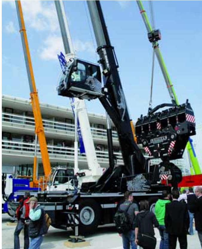
Doppelfunktion: Die Kabine des neuen Kompaktkrans LTC 1045-3.1 dient gleichzeitig als Fahr- und Krankabine.
