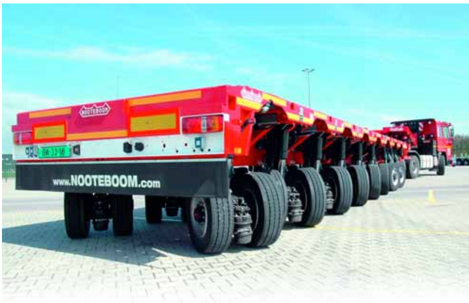
Neue Produktreihe: Konstruktion und Komponenten des MCO-PX-Multitrailers basieren auf dem PX2-Tieflader.
