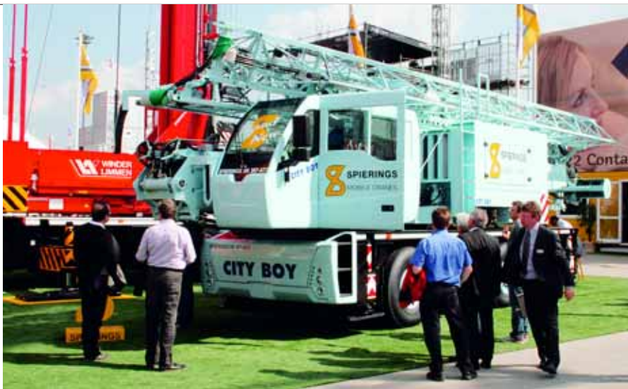
Alternativer Vortrieb: Der neue SK387-AT3 ist ein mobiler Faltbaukran mit multifunktionaler Fahrerkabine und elektrischem Antrieb.
